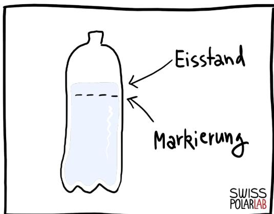
Wie Sie auf dem Diagramm sehen, liegt der Pegel des Eises über der Markierung, die auf die Flasche gemalt wurde als das Wasser flüssig war.
